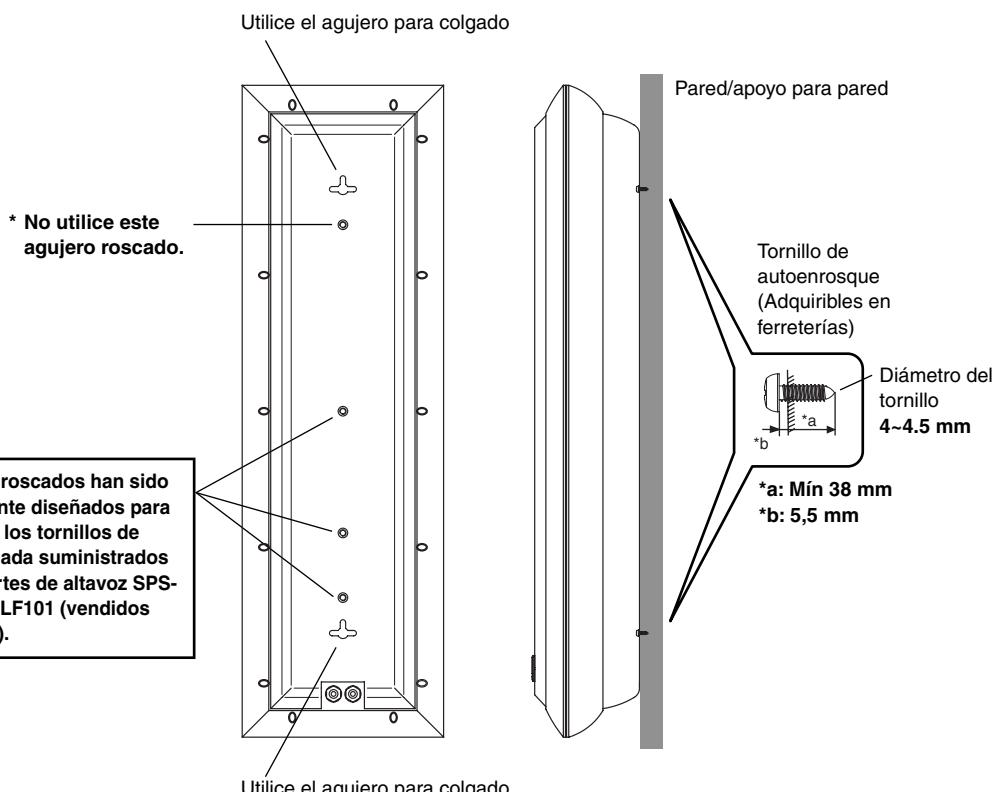
Los agujeros roscados han sido específicamente diseñados para utilizarse con los tornillos de rosca de pulgada suministrados con los soportes de altavoz SPS-HF101 y SPS-LF101 (vendidos por separado).
