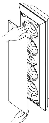
La tapa frontal está fijada a la caja del altavoz en cuatro puntos, y puede extraerse si se desea. Para extraer la tapa, sujetela por ambos lados y tire directa y suavemente de ella hacia afuera del altavoz. Para volver a colocarla, alinee los cuatro agujeros de la superficie interior de la tapa con las cuatro espigas correspondientes del altavoz, y empújela suavemente.
