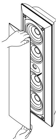
Die Frontabdeckung ist an vier Stellen am Gehäuse befestigt. Falls erwünscht, können Sie sie abnehmen. Fassen Sie sie hierzu an beiden Seiten an, und ziehen Sie sie langsam vom Lautsprecher ab. Um die sie wieder anzubringen, richten Sie die vier Öffnungen an der Innenseite der Abdeckung auf die vier Stifte des Lautsprechers aus, und drücken Sie die Abdeckung vorsichtig auf den Lautsprecher.
