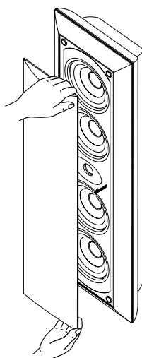
Le couvercle avant, fixé à l'enceinte en quatre points, peut être retiré si désiré. Pour retirer le couvercle, le saisir par les deux côtés et le tirer lentement droit vers soi. Pour le remettre en place, aligner les quatre orifices de la surface interne du couvercle sur les quatre fiches correspondantes de l'enceinte et appuyer doucement.
