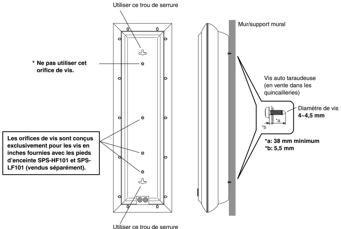
Visser les vis dans un mur ou un support mural solide comme indiqué sur la figure, et accrocher l'enceinte en insérant les vis en saillie dans les orifices du panneau arrière.
