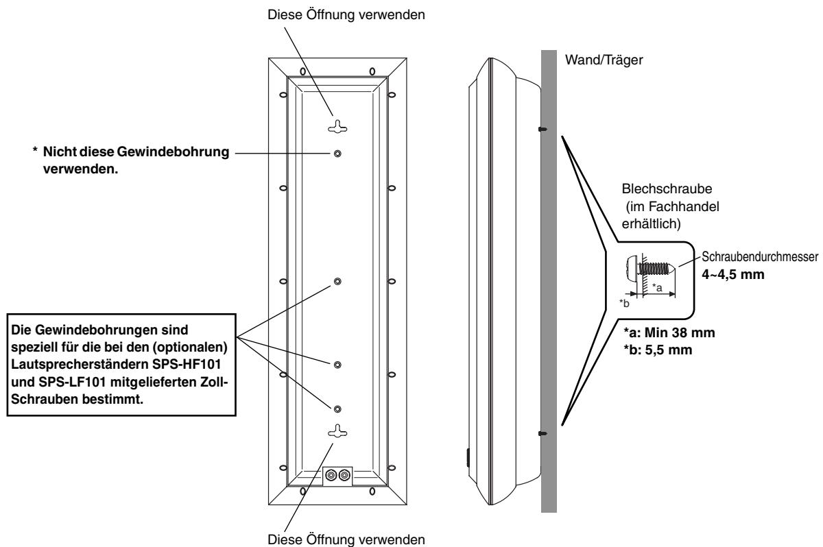
Schrauben Sie Befestigungsschrauben so an einer stabilen Stelle in die Wand oder einen Träger, dass sie etwas herausstehen und befestigen Sie die Lautsprecher daran.
