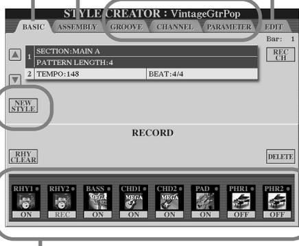
Wenn Sie diese Taste drücken, wird für Parts, die Daten enthalten, DELETE (Löschen) angezeigt. Um alle Daten eines Parts zu löschen, drücken Sie die entsprechende obere LCD-Taste, während Sie diese Taste DELETE gedrückt halten. Der Löschvorgang wird ausgeführt, sobald Sie diese Taste loslassen.
