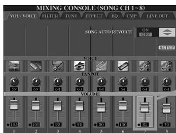
In diesem Display (Mischpult) ist der zur Bearbeitung ausgewählte Parameter hervorgehoben dargestellt. Der Parameter kann mit dem Datenrad angepasst werden.
